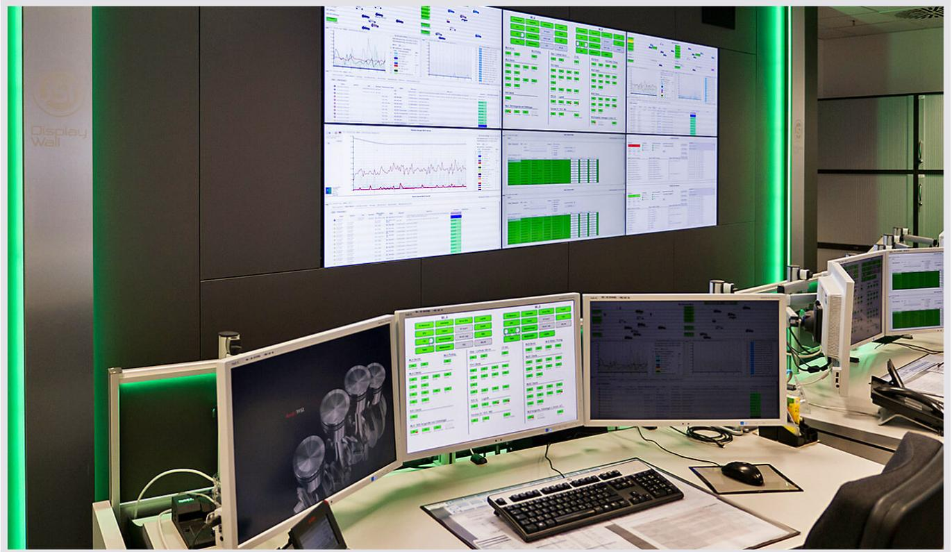
JST Großbildwand: Die JST-DisplayWall mit 6 Stück 46“-Displays hält das gesamte Kontrollraumteam über die wichtigsten Ereignisse in Realtime informiert. Dafür sorgt eine automatische Quellenaufschaltung, die JST-PixelDetection-Software.
