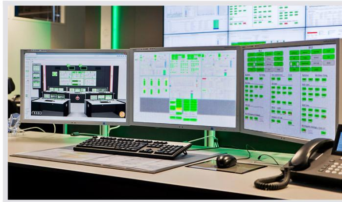
JST MultiConsoling®: Die myGUI – hier dargestellt auf dem linken Bildschirm – dient als Bedienoberfläche für das MultiConsoling®, mit dem es möglich ist, beliebige Quellen in Echtzeit auf die Arbeitsplatzmonitore, auf einzelne Großbild-Displays oder als BigPicture über mehrere Großbild-Displays hinweg darzustellen. Eine weitere Besonderheit: Pro Platz sind nur noch eine Maus und Tastatur nötig, um alles in Realtime zu bedienen.
