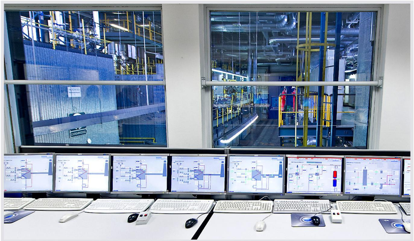
JST Lösungen: Da die Bildschirme hinter der Arbeitsplatte um zehn Zentimeter abgesenkt sind, ist der ungehinderte Blick in die Halle möglich. Zudem wird dadurch die Blicklinie aus der Waagerechten um 35° abgesenkt und sorgt für eine entspannte Kopfneigung (Empfehlung der Verwaltungsberufsgenossenschaft).
