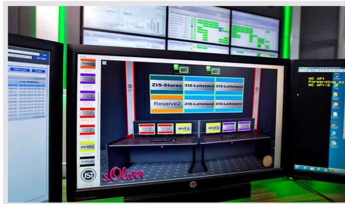
JST MultiConsoling®: Der Monitor zeigt die myGUI-Bedienoberfläche für das MultiConsoling®. Gut zu erkennen: Während früher lediglich eine Konsole pro Arbeitsplatz zum Einsatz kam, wurde nun dank der positiven Erfahrungen mit der innovativen JST-Technik auf insgesamt drei Konsolen je Arbeitsplatz aufgestockt, das heißt, jeder Bildschirm im s.Oliver Leitstand läuft heute über MultiConsoling®.
