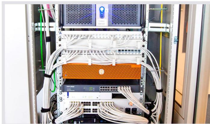
JST Technik: Der orangefarbenen JST-Applikations-Server mit der JST-PixelDetection-Software®. Darunter: das Herzstück des JST-MultiConsoling® – das MultiCenter. Mit MultiConsoling® werden alle dazustellenden Rechner und Kameras auf die DisplayWall oder auf die Monitore der Arbeitsplätze geschaltet und in Realtime mit Maus und Tastatur bedient. Dadurch erhalten die Nutzer größtmögliche Flexibilität unter Einhaltung aller IT-Sicherheitsrichtlinien.
