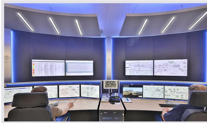
**Bild 4** | JST Akustikdeckensegel: Reduzierung des Schallpegels und innovative Beleuchtungslösung – das Deckensegel OPAL X11 bietet eine spannende Alternative zur kostspieligen Akustikdecke im Kontrollraum.
