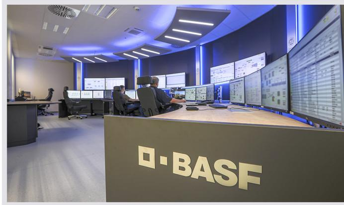
**Bild 6** | Blendfreies Licht, Schallabsorption und raumprägendes Designelement – die Vorzüge des Akustikdeckensegels sind bei BASF in Schwarzheide deutlich.
