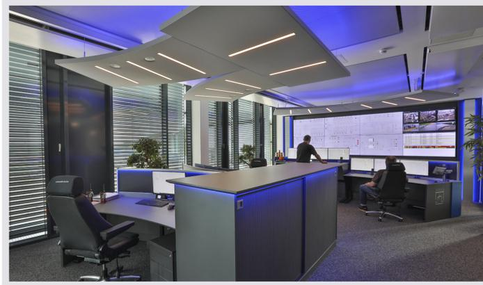
**Bild 9** | Moderne und ergonomische Arbeitsplatzgestaltung in der hochverfügbaren NWKG Steuerwarte: Für jeden Arbeitsbereich wurde zugunsten optimaler Beleuchtung und Schallabsorption ein exakt abgestimmtes Akustikdeckensegel installiert.
