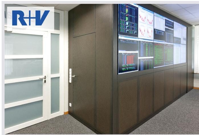
**JST-Großbildtechnik:** Die sechs LC-Displays sind perfekt in die schallabsorbierende Großbildwand eingepasst. Seitlich befindet sich eine Tür, die...
