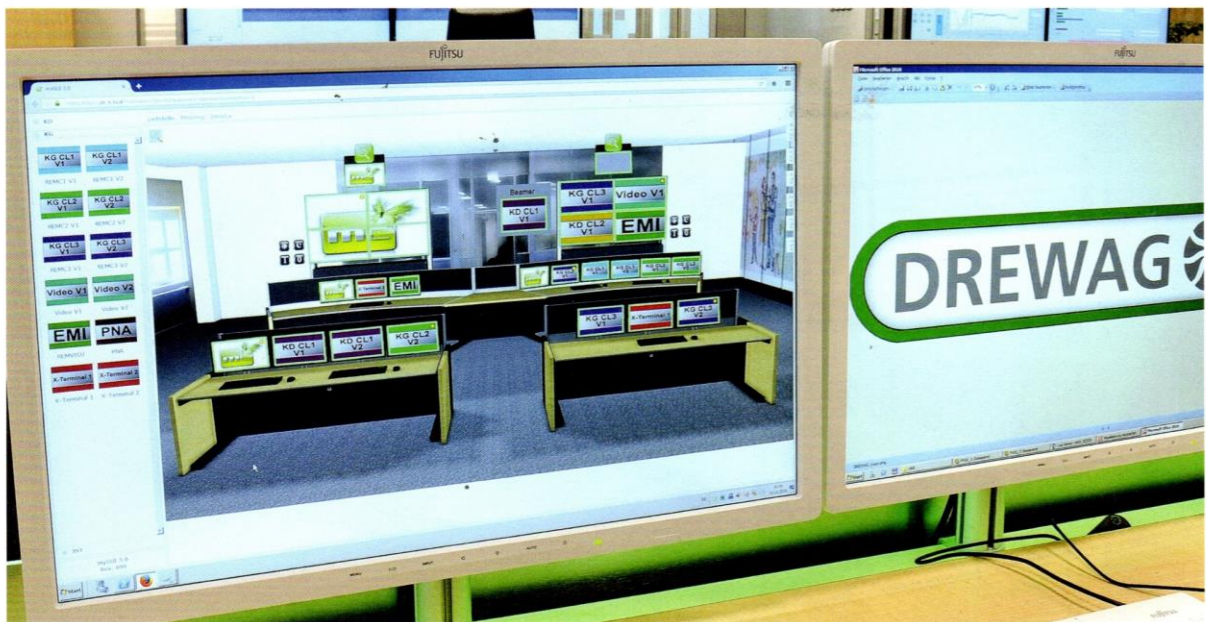
Bild 2. Für eine komfortable und intuitive Bedienung der verschiedenen Systeme sorgt die myGUI-Bedienoberfläche. In dieser interaktiven 3D-Oberfläche für das MultiConsoling werden alle Konsolen der Arbeitsplätze und die Großbildwand als »Kontrollraumbild« dargestellt, das heißt als grafisches Modell der Leitwarte.
