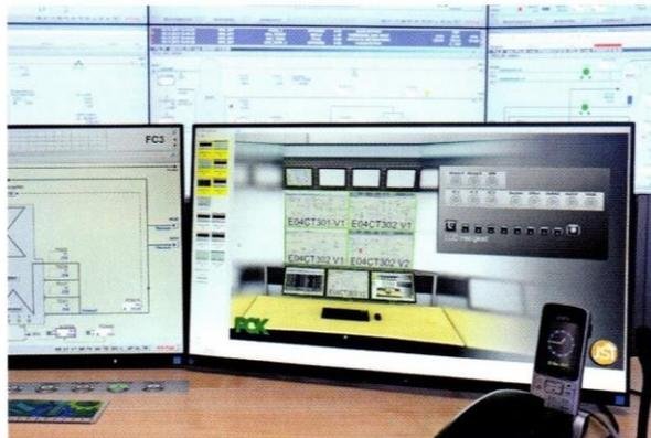
MultiConsoling korreliert Monitore, das heißt, der Anlagenfahrer holt sich immer die Anzeige auf einen der eigenen Bildschirme, die er gerade braucht. An einem Arbeitsplatz können bis zu 1.000 verschiedene Prozessbilder aufgeschaltet werden.
