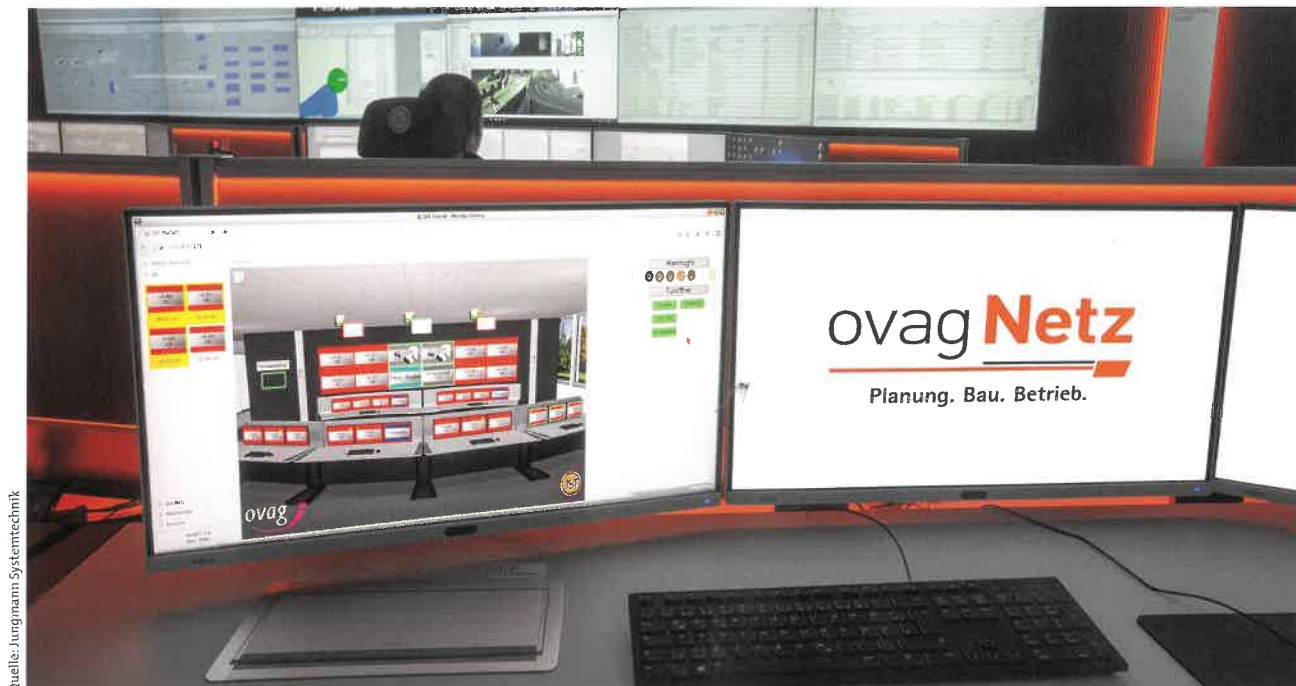
Bild 5. Die myGUI-Bedienoberfläche ermöglicht eine mühelose und souveräne Lenkung der gesamten Infrastruktur im Leitstand. Dabei handelt es sich um eine interaktive 3D-Oberfläche, mit der sich auch sehr komplexe Kontrollraumtechnik schnell, sicher und intuitiv steuern lässt. In dieser Multi-Consoling-Komponente werden die Monitore der Arbeitsplätze und die Großbildwand als 3D-Kontrollraumbild dargestellt.
