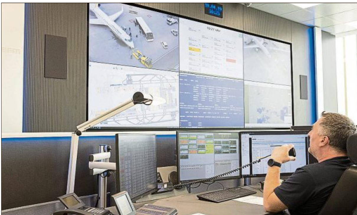
Mit der speziellen MultiConsoling-Technik können auf den Arbeitsplatzmonitoren und der Display Wall flexibel verschiedene Systeme, Daten oder Kameras aufgerufen werden.
