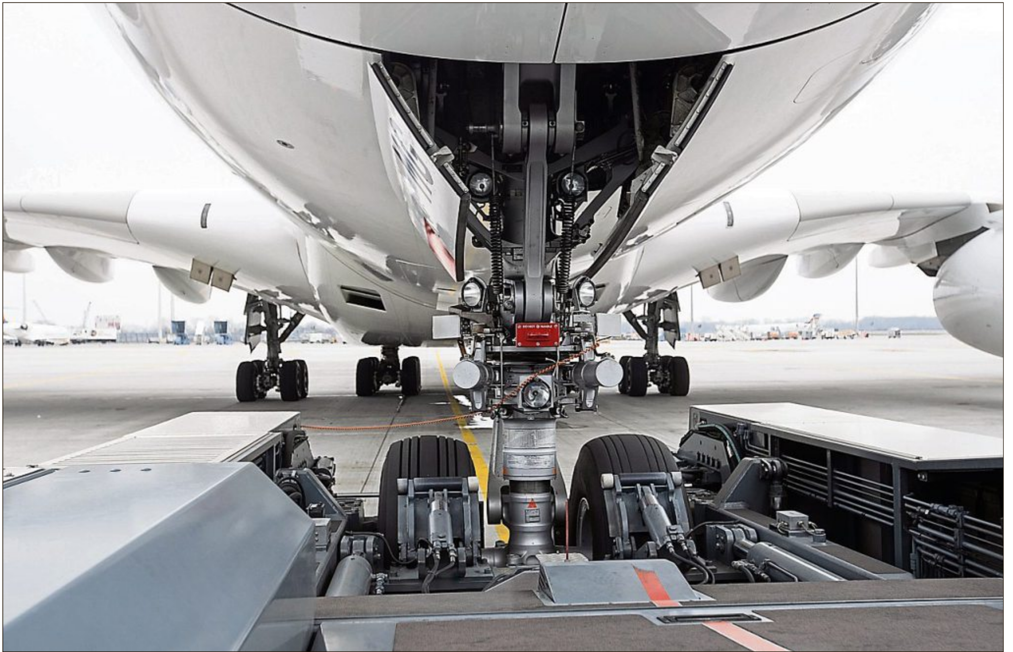
Aus dieser Perspektive sieht der Schlepperfahrer die Flugzeuge, die er aus der Parkposition herausbugsiert muss.
