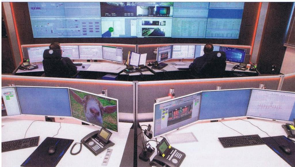
Bild 3. JST installierte eine besondere MultiConsoling-Technik, mit der auf der DisplayWall und den Arbeitsplatzmonitoren flexibel verschiedene Systeme aufgerufen werden können
