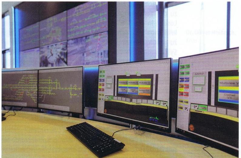
Bild 4: In der interaktiven 3D-Bedienoberfläche myGUI werden alle Konsolen der Arbeitsplätze und die Großbildwand als „Kontrollraumbild“ dargestellt
