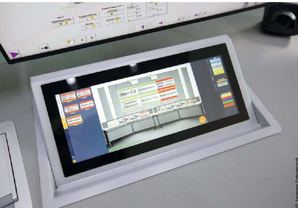
Auf dem Command-Pad, einem im Kontrollraumpult integrierten Touchdisplay, ist die MyGUI aufgeschaltet. Auf dieser interaktiven 3D-Oberfläche sind die Monitore der Arbeitsplätze und die Großbildwand als „Kontrollraumbild“ dargestellt. Links an der Seite sind alle benötigten Quellen abgebildet und können über ihre individualisierbaren Icons einfach auf die Multikonsole oder die Display-Wall gezogen und bedient werden.
