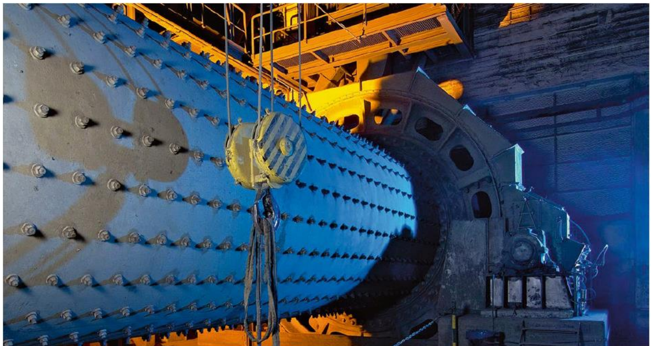
Bild 1 Zementklinker wird in der Zementmühle zum Endprodukt Zement vermahlen. (© HeidelbergCement)
