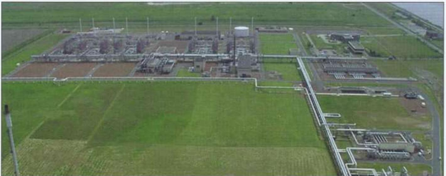
**Bild 1:** GASSCO betreibt im ostfriesischen Emden das Norse Sea Gas Terminal sowie die Europepipe Metering Station (EMS). Am Terminal (im Bild) werden Druck und Temperatur des Gases geregelt, bevor es eine Aufbereitungsanlage zur Entfernung von Schwefelwasserstoff durchläuft.
