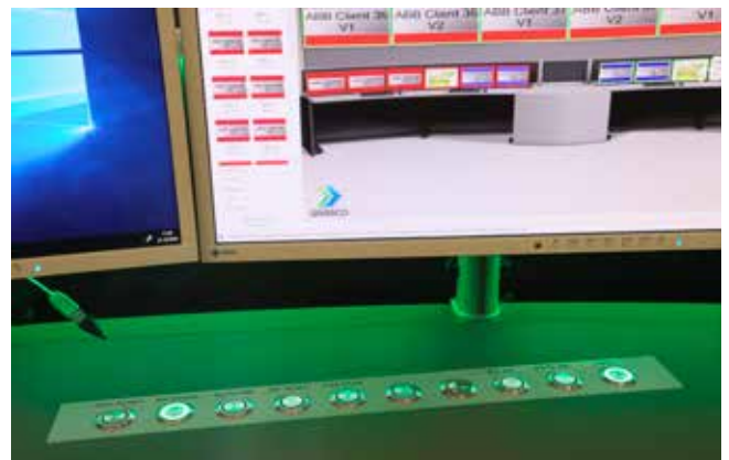
Über die CommandButtons können auf Knopfdruck blitzschnell vordefinierte Szenarien auf die Monitore am Pult und auf die Großbildwand aufgeschaltet werden.
