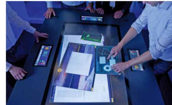
↑ **JST TacticTable®:** Ob Anwendungen aus dem Leitstand oder Darstellungen externer Nutzer - unterschiedliche Daten können gleichzeitig in gewünschter Größe frei positioniert werden.
