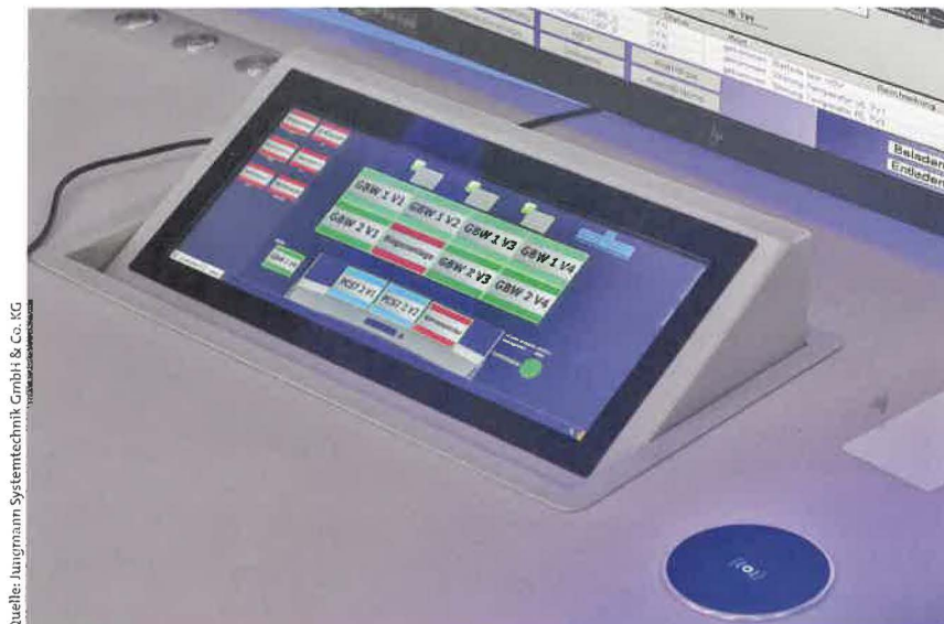
Das JST CommandPad spiegelt mit der myGUI-Bedienoberfläche den Arbeitsplatz des Operators wider und ermöglicht ihm den direkten, verzögerungsfreien Zugriff auf alle Quellen des Leitstands.
