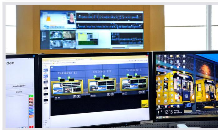
**JST MultiConsoling®:** Die myGUI – hier dargestellt auf dem mittleren Bildschirm – dient als Bedienoberfläche für das MultiConsoling®, mit dem es möglich ist, beliebige Quellen (Rechner, Kameras etc.) in Echtzeit auf die Arbeitsplatzmonitore, auf einzelne Großbild-Displays oder als BigPicture über mehrere Großbild-Displays hinweg darzustellen.
