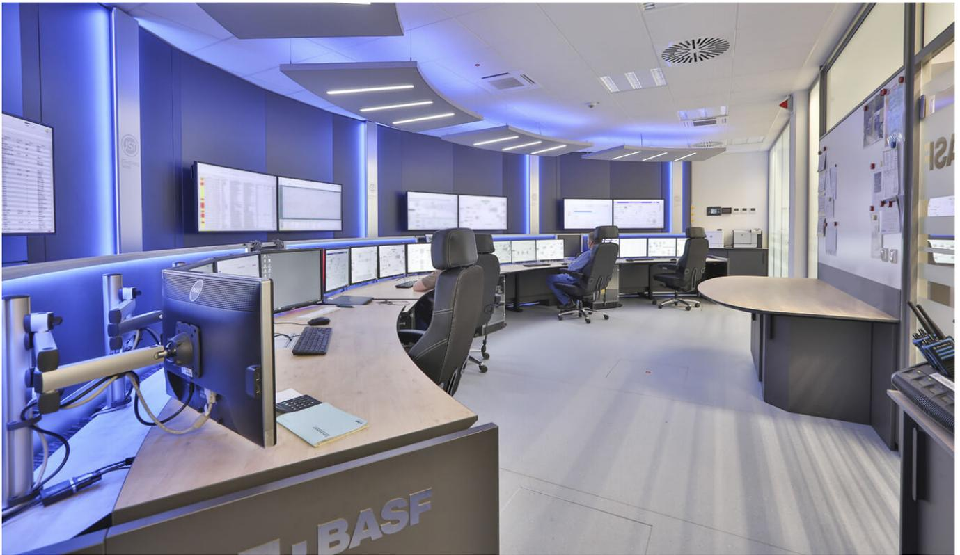
Die optischen Gestaltungsmöglichkeiten, die das „Operator Acoustics Light – Opal X11®“ bietet, kommen im BASF Leitstand Schwarzhilde besonders zur Geltung: Das Deckensegel wurde der halbrunden Form des Stratos Curve Kontrollraum-pults angepasst.
