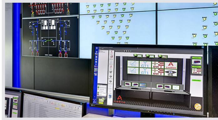
JST MultiConsoling®: Das Foto zeigt die JST myGUI, die Bedienoberfläche für das MultiConsoling® – Rechner werden hiermit einfach und intuitiv auf die Arbeitsplatz-Monitore und die Großbild-Displays verschaltet. Pro Platz ist nur noch eine Maus und Tastatur nötig.
