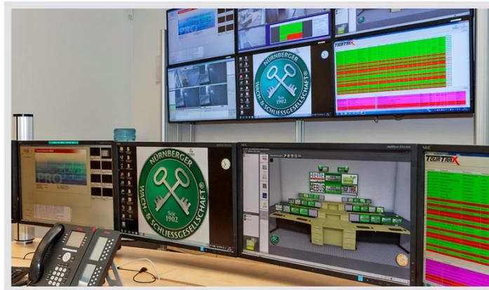
**JST MultiConsoling®**: Die myGUI – hier dargestellt auf dem zweiten Bildschirm von rechts – dient als Bedienoberfläche für das MultiConsoling®. Vorteil dieser Technik: Rechnersignale mit Keyboard-, Video-, Maus-, Audiosignalen und Kameras werden flexibel auf den Monitoren am Arbeitsplatz oder auf der Großbildwand dargestellt.
