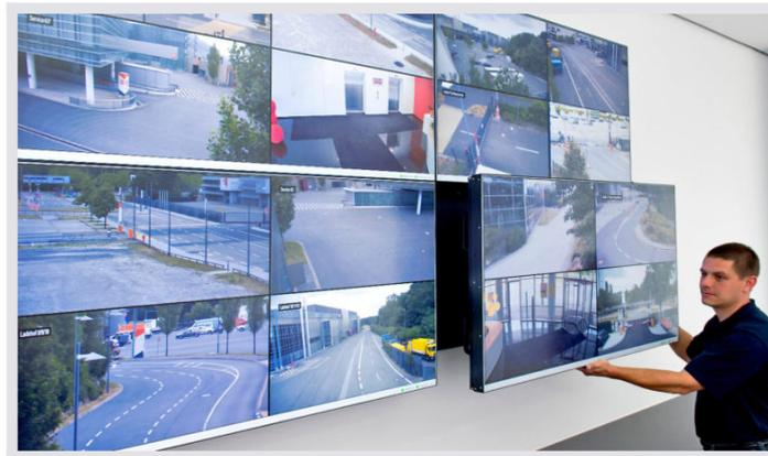
**JST QuickOut-Montagesystem:** Die Großbild-Displays werden platzsparend direkt an der Wand montiert. Durch leichten Druck auf die Display-Außenkanten schiebt sich jedes einzelne Display nach vorn (Quick-Out), um im Revisionsfall den Zugang zu rückwärtigen Anschlüssen und Technik-Komponenten zu gewährleisten.
