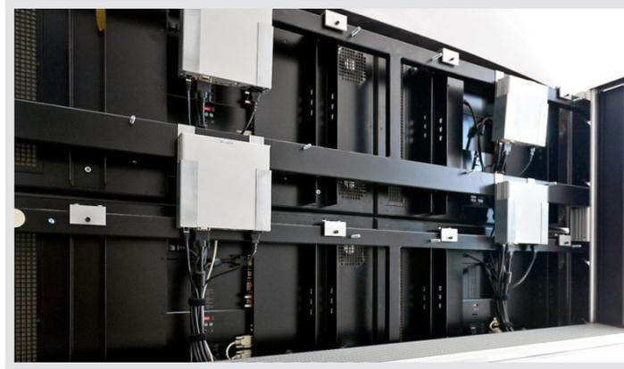
**JST Großbildtechnik**: Die rückwärtige Perspektive der Großbildwand zeigt nicht nur die millimetergenau eingepassten Displays; auch die MultiConsoling®-Stations, die mit den MultiCentern verbunden sind, lassen sich hier perfekt erkennen.
