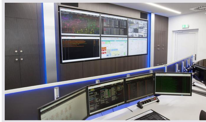
JST DisplayWall®: Perfekt in Design und Verarbeitung – die DisplayWall®. Designstreifen mit hochwertiger Alu-Brushed-Oberfläche und das AlarmLight geben der Monitorwand die besondere Optik. Die 46 Zoll großen LC-Displays wurden perfekt in die schallabsorbierende Verkleidung der Großbildleinwand eingepasst.
